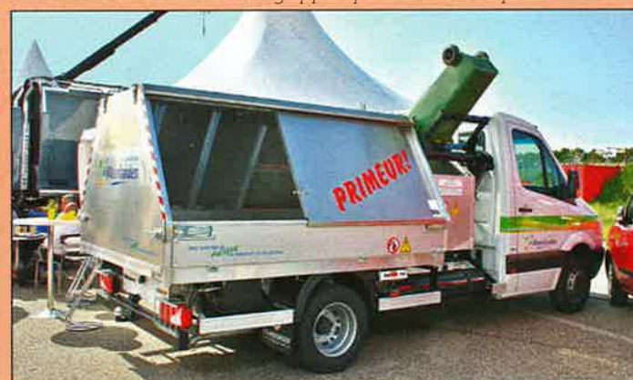
Karhof veegvuilopbouw speciaal aangepast voor de MB sprinter met CNG-motor.
