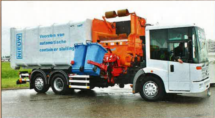
Er was volop gelegenheid om noviteiten zelf in de praktijk te testen, zoals deze Mercedes Eonic die is opgebouwd met de E-Maxx dubbele grabber en automatische containersluiting van Translift.
